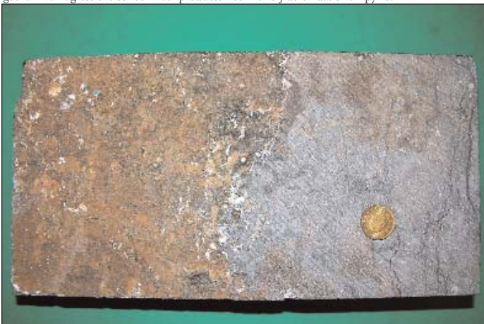
Bovenaanzicht van schuin aangesneden bruin verkleurde zone in verkleurde boordsteen, vervaardigd in Petit Granit (COPRO-staal)
